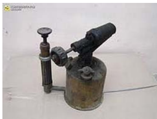
24. ábra. Benzinlámpa – égetéses eltávolításhoz 17
