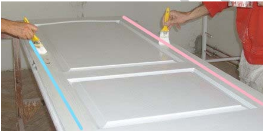
19. ábra. Ajtólap felhelyezése a lakkállványra
