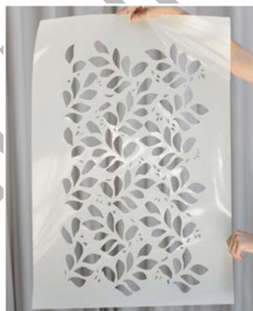
6. ábra. Műanyag fóliából készült sablonok (kivághatók például 0,25–0,5 mm-es vastagságú PVC fóliából, vagy 1–2 mm vastag plexilemezből).
