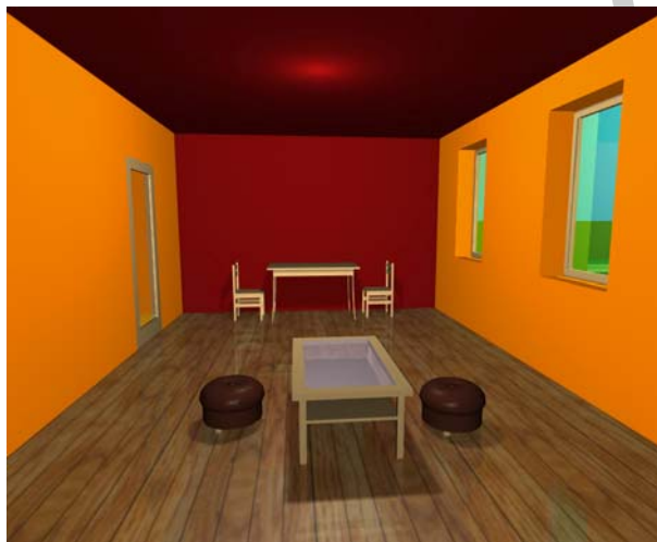
18. ábra. Ha még a mennyezetet is sötétebb megre festjük, akkor csökkenő belmagassággal és további rövidüléssel számolhatunk, vagyis a hátsó fal még közelebbinek hat.
