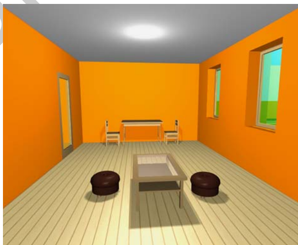
19. ábra. Világos színű padlóval és mennyezettel az oldalfal színétől függetlenül erőteljes belmagasságnövekedést érünk el látszatra; szinte "túlvilági" a helyiség.
