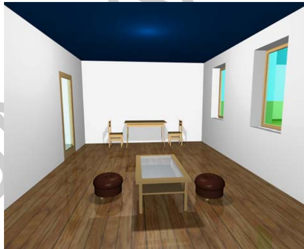
16. ábra. A sötét színűre festett mennyezet látásra csökkenti a belmagasságot, hiába hideg színű. Ha a mennyezet és a padló sötét, a helyiség szélesebbnek hat.
