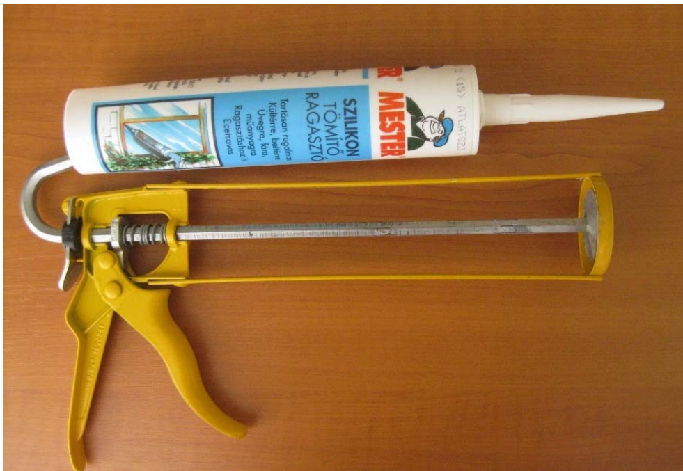
4. ábra. Hézag tömítőanyag és kinyomó pisztoly 4
