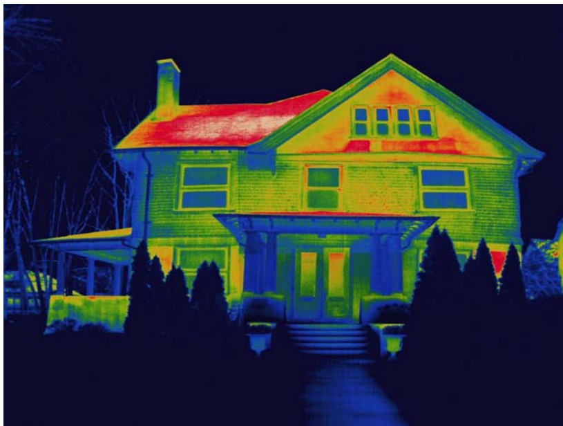
10. ábra Az épület diagnosztikában alkalmazott hőtérkép megmutatja, hogy háznak melyik részein gyenge a hőszigetelése, hol kell javítani azon 10
