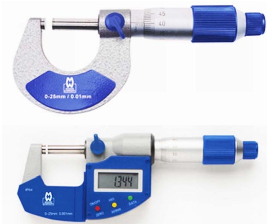
47. ábra. Hagyományos és digitális mikrométer 11
