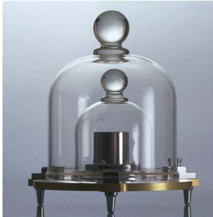
4. ábra. 1 kg tömegű platina-íridium etalon 3
