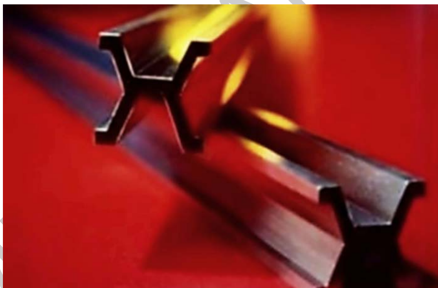
3. ábra. A méter platina-irídium etalonjai 2
