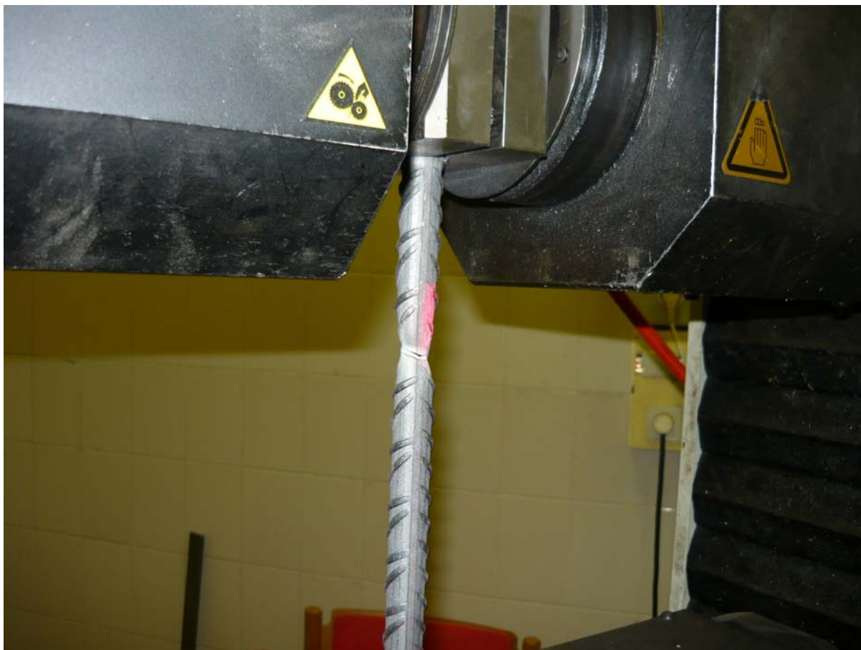
3. ábra. Szakítószilárdság-vizsgálat építőanyag laboratóriumban
