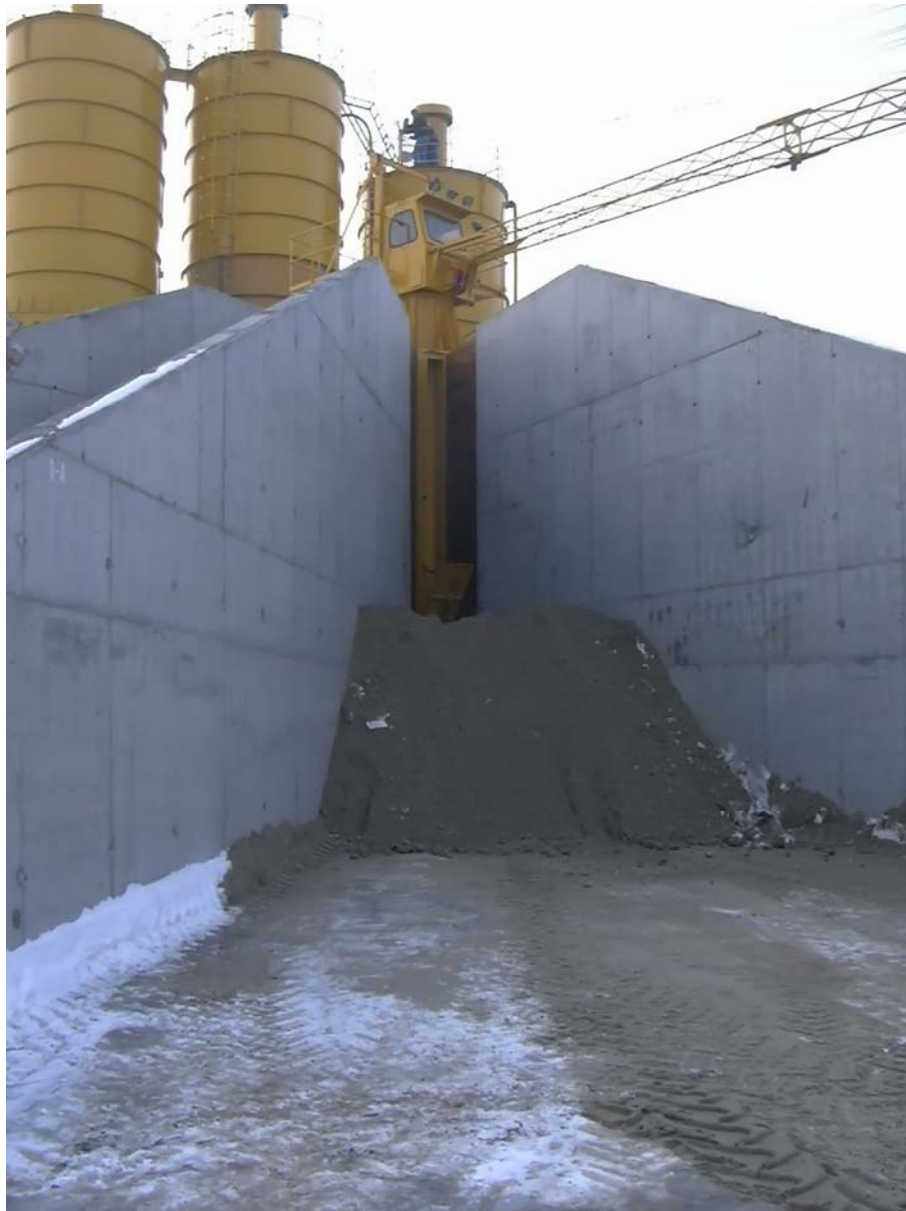
14. ábra. Csillagdepós tároló kotróművel
