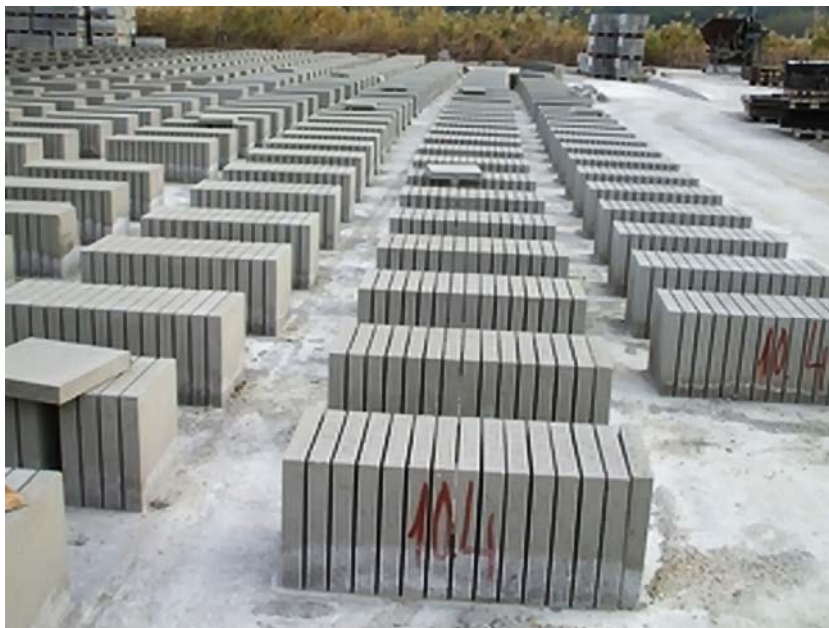
19. ábra. Beton járólapok kültéri tárolása 8
