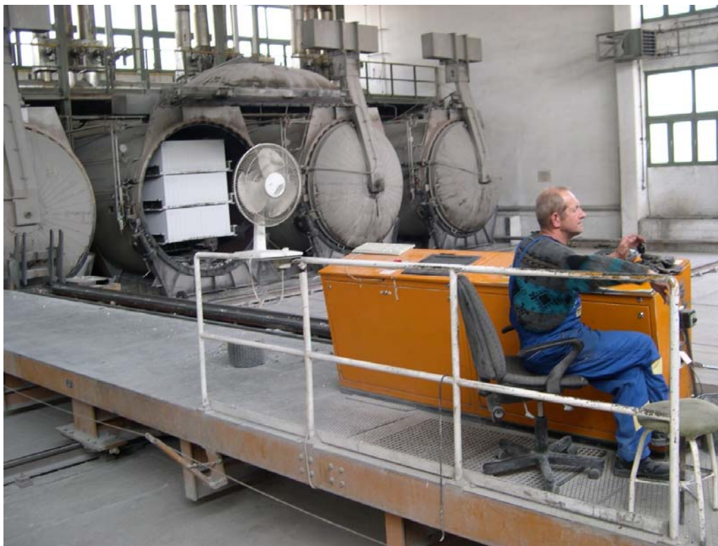
7. ábra. Autokláv (nagy nyomású gőzérlelő berendezés) és a kezelőpult
