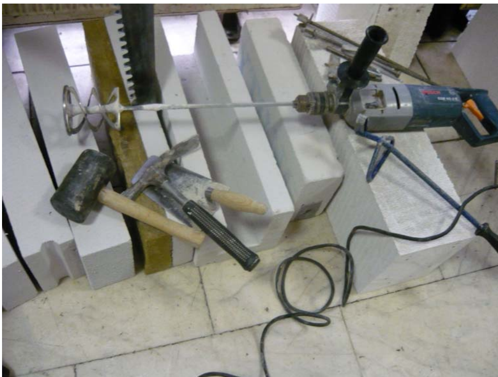
9. ábra. Keverőszár javítóhabarcsok keveréséhez
