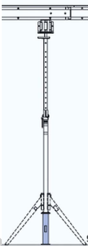
9. ábra. Nagy teherbírású födémtámasz, támasztólábbal, ejtőfejjel 1
