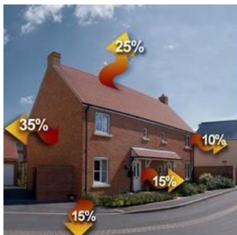
1. ábra A különböző felületek hő veszteségei.1
