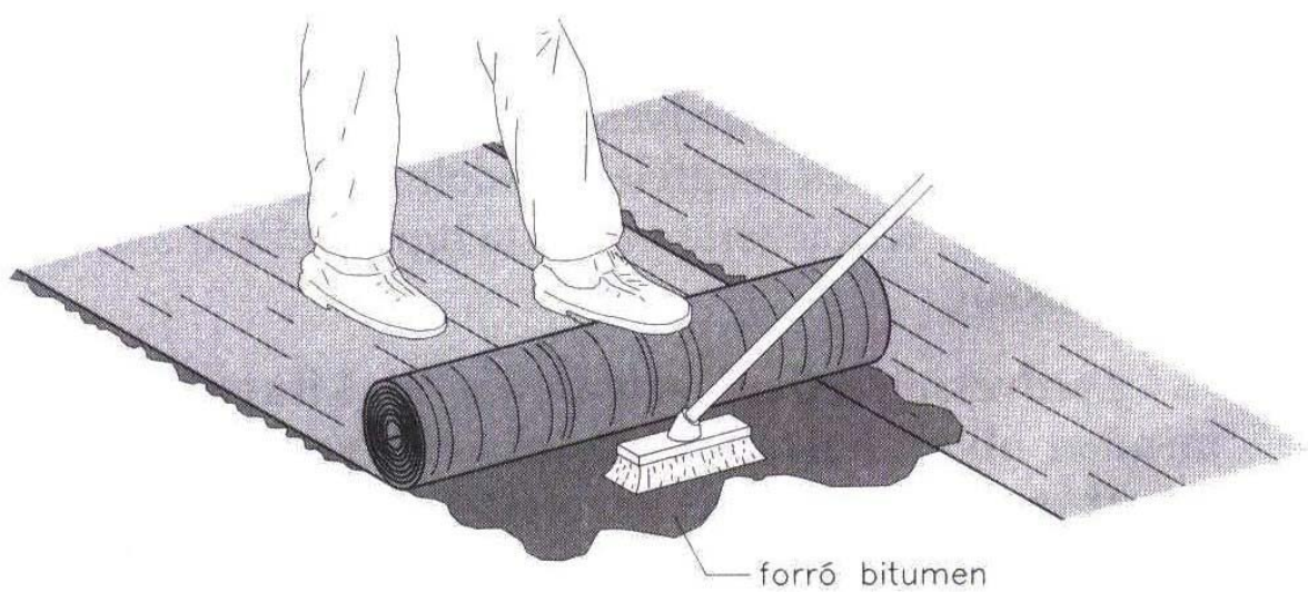
37. ábra Lemez szigetelés fektetése.
