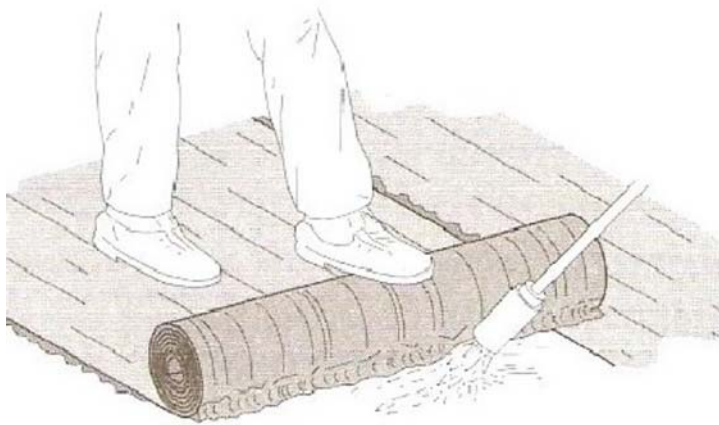
15.ábra. Lángolvasztásos ragasztás 15
