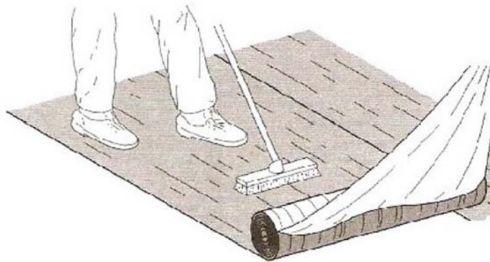
20.ábra. Öntapadólemez fektetése 20
