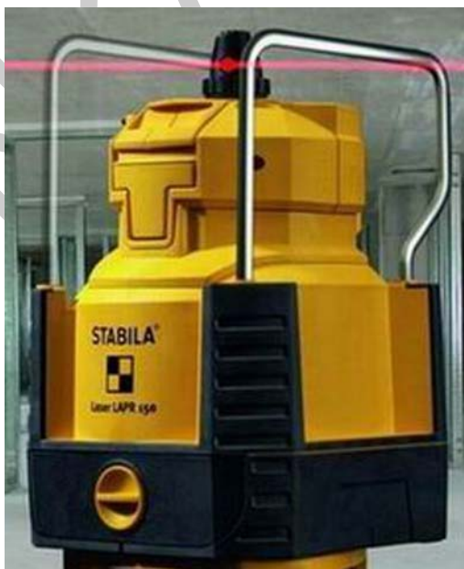
26. ábra. Stabila LAPR 150 önbeálló forgólézer 18
