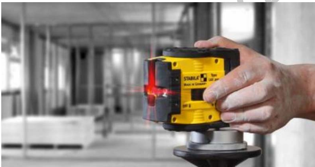
28. ábra. Kitűzés önbeálló keresztlézerrel 12
