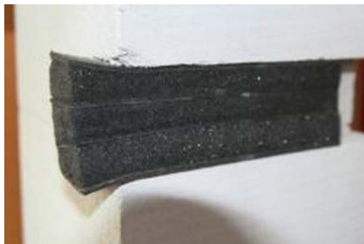
53. ábra. Az egymásra ragasztott, előre gyártott „szendvics szerkezet” 42
