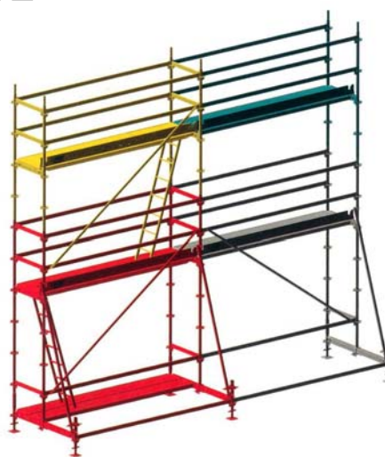
13. ábra. Mobil állvány betonacél szereléshez 14. ábra. Mobil állvány munkaszinttel, létrával
