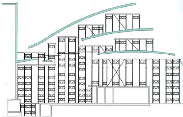
6. ábra. Egyedi formájú födém, zsalu alátámasztási vázlata és a kész födémszerkezet
