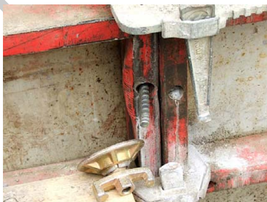
24. ábra. A keretes falzszaluzat bordája deformálódott az átkötési helynél 26
