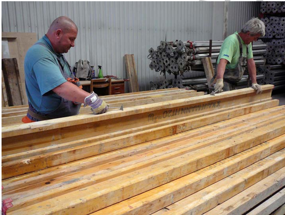
17. ábra. Fatartók átválogatása, szögtelenítése, és tisztítása kaparó szerszámmal 19
