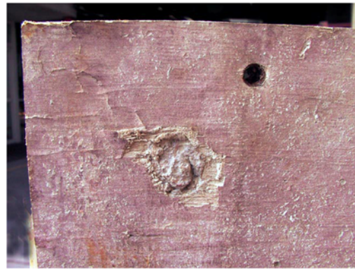
10. ábra. Szétvált zsaluhéj – Felsértett felületű fa zsaluhéj 10
