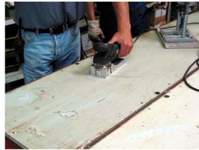
15. ábra. Fa zsaluej javítás-, műanyag zsaluej javított felületének simítása 16
