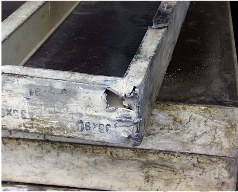
2. ábra. Alumínium keretes falzsalu elem, keretcserére szorul 2
