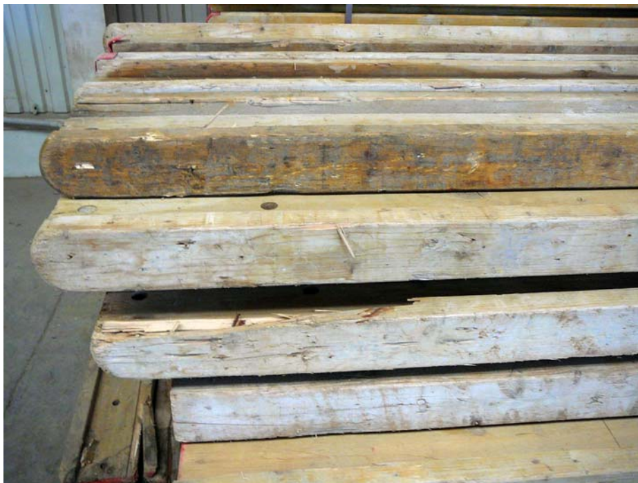
18. ábra. Tisztítatlan, sérült fatartók átvizsgálás előtt 20
