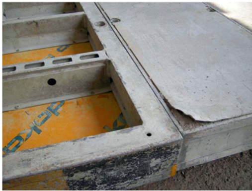
10. ábra. Szétvált zsaluhéj – Felsértett felületű fa zsaluhéj 10
