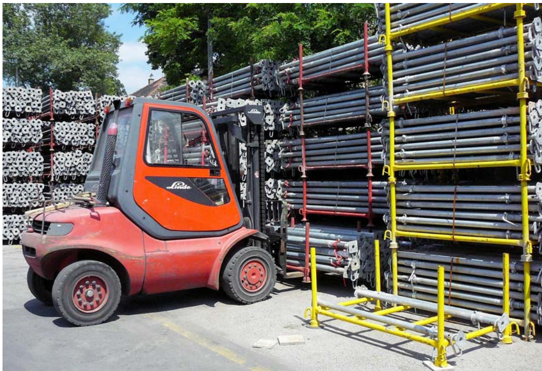
24. ábra. Tároló kalodában levő födém támasz kötegek mozgása, targoncával 27
