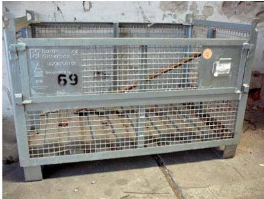
9. ábra. Lehajtható előlapú tároló kosár – alkatrész konténer a különböző típusú elemekhez 9
