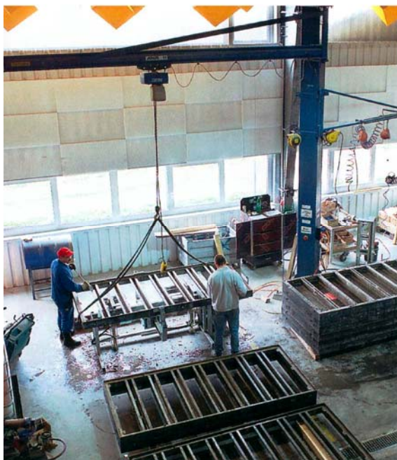
27. ábra. Javítóműhelyben, zsaluelemet mozgó bakdaru (a). – Átkötés nélküli, műanyag zsaluelemmel borított magas falzsalu szerkezetének mozgatás egyedi bakdaruval(b) 31
