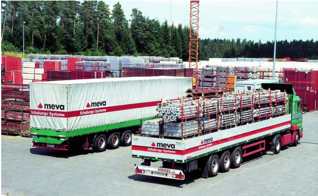
29. ábra. Szállítójárműre szabályosan elhelyezett zsaluezat rakatok lefogatása spaniferrel 33
