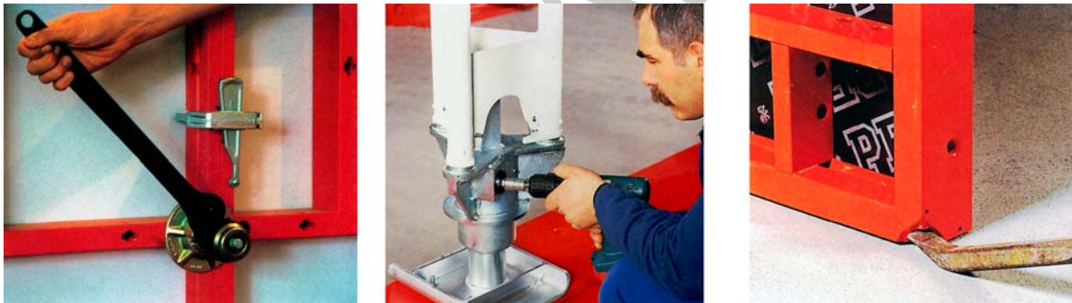
12. ábra. Racsnis anyabeajtó kulcs SW 27 (SW 36) (a) 14 – Csavarbeajtó (b) 15 – Feszítővas a falzsalu elem kizsaluzásához (c) 16
