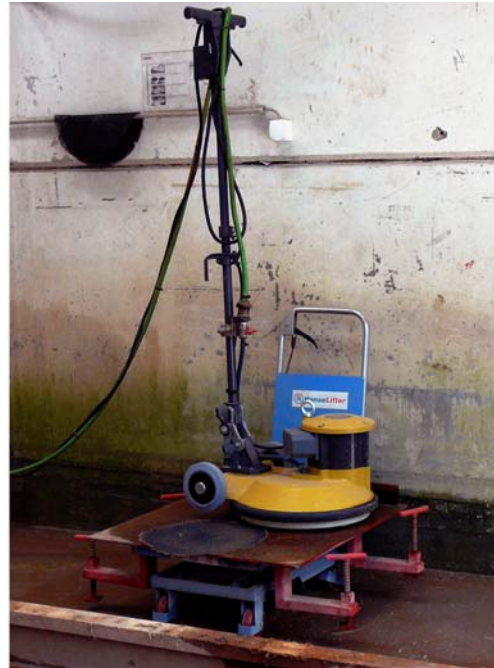
18. ábra. Nagynyomású mosóberendezés – Vizes forgótárcsás felület tisztítógép 21
