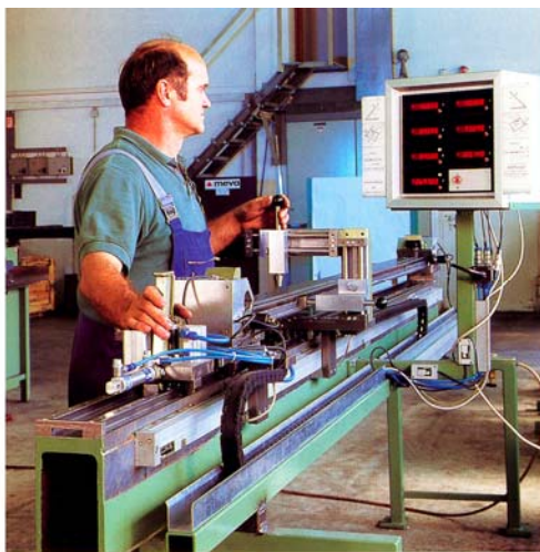
2. ábra. Zsalu profilok, kapcsoló elemek terhelhetőségének ellenőrzése 2
