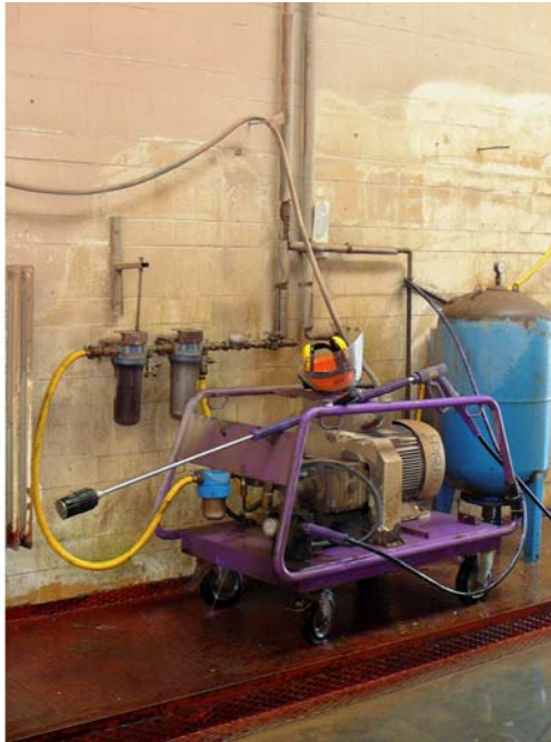
18. ábra. Nagynyomású mosóberendezés – Vizes forgótárcsás felület tisztítógép 21
