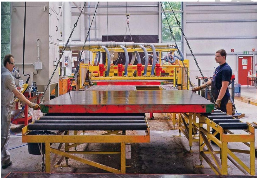
17. ábra. Porelszívóval felszerelt, fémkeretes zsaluelemeket tisztító gépsor 20
