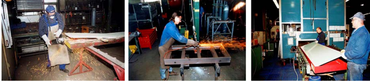
28. ábra. Keretes falzsalu elemek javítása 32
