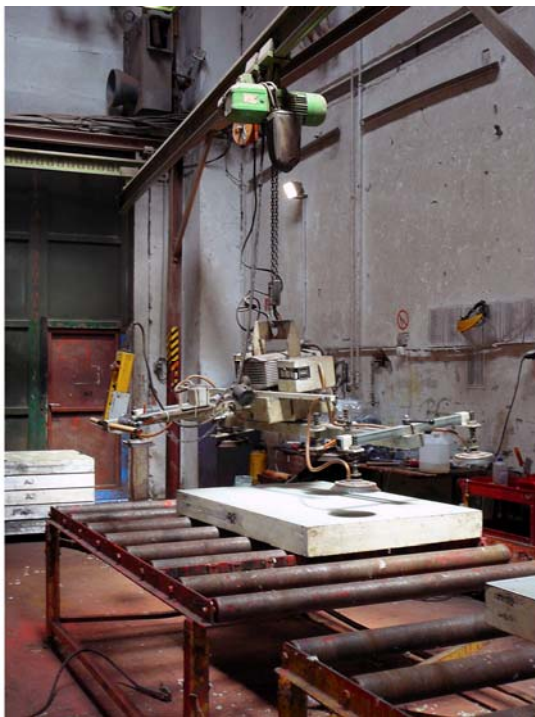
16. ábra. Függő futódaru, tapadókorongos emelőszerkezettel – Alkatrésztisztító berendezés 19
