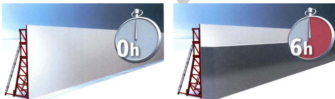
8. ábra. Betonozás során mozgóteher terheli a zsaluzatot, ahol kivilágosodott a beton ott már megindult a kötés és nem terheli a zsaluzatot
