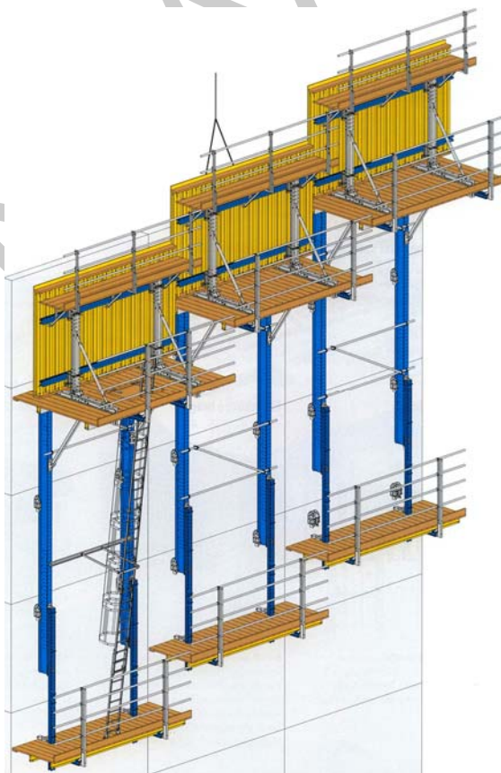
24. ábra. Építményen vezetett kúszórendszer
