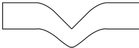
4. ábra. Próbatest alakja a behasadási ellenállás méréséhez
