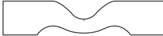
5. ábra. Próbatest alakja a továbbhasadási ellenállás méréséhez
