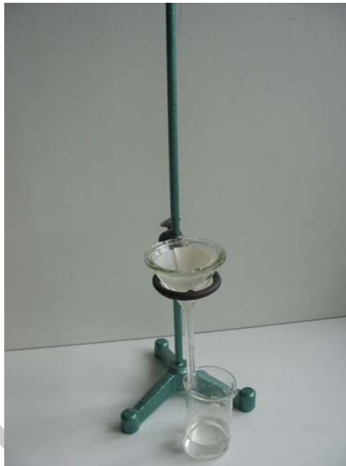
5. ábra. Légekőri szűrés analitikai tölcséren
