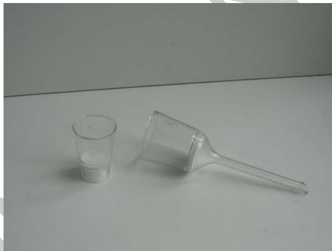
7. ábra. Vákuumszűrés zsugorított üvegszűrő tölcserrel
