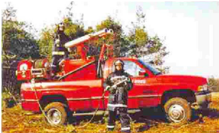
26. ábra. Gépjárműre szerelt impulzusoltó
