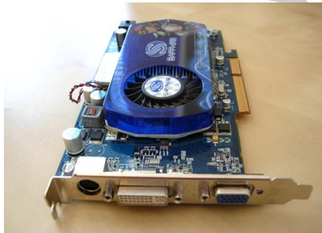
19. ábra. Videokártya, fehér a DVI csatlakozó, kék a VGA
