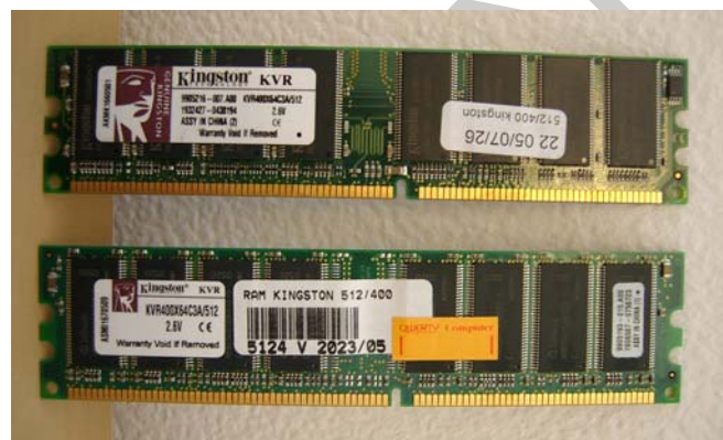
17. ábra. Két Kingston DDR 1-es 512 Mbyte/400Mhz memória modul
