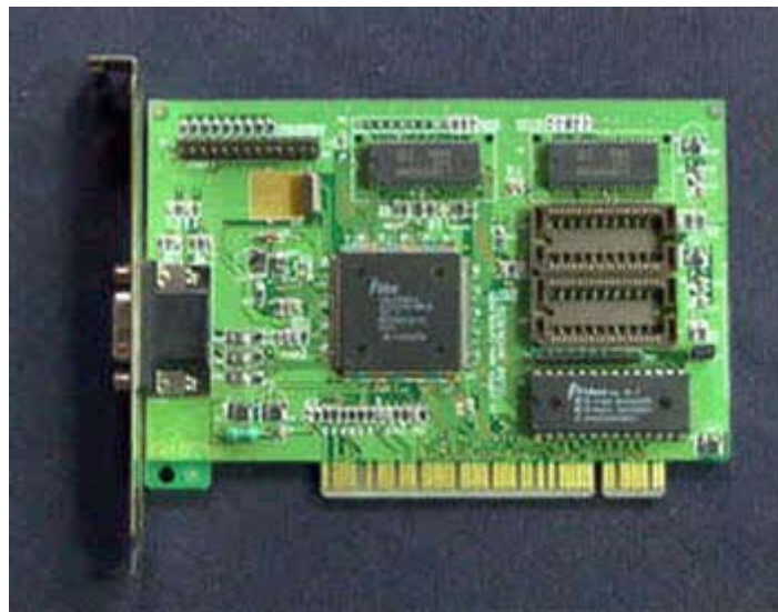
33. ábra Grafikus – SVGA kártya (forrás: sdt.sulinet.hu)
