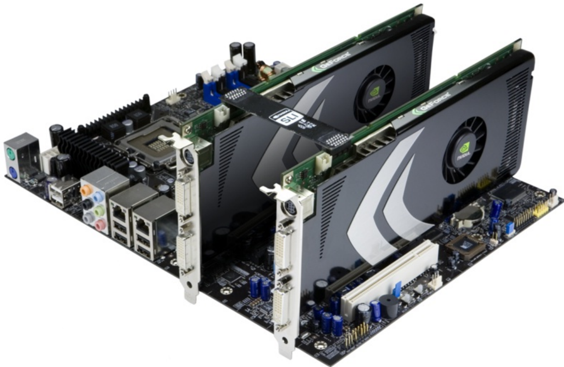
34. ábra Több videokártya hídba kötve (forrás: Wikipédia)
