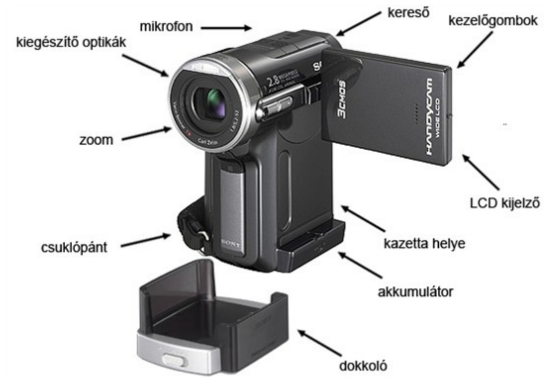
41. ábra: Digitális videokamera részei (forrás: sdt.sulinet.hu)
