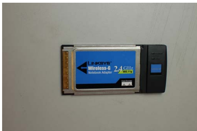
8. ábra. Vezeték nélküli hálózat csatoló kártyája
