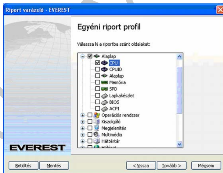
24. ábra. A CPU jellemzők jelentésének előkészítése
