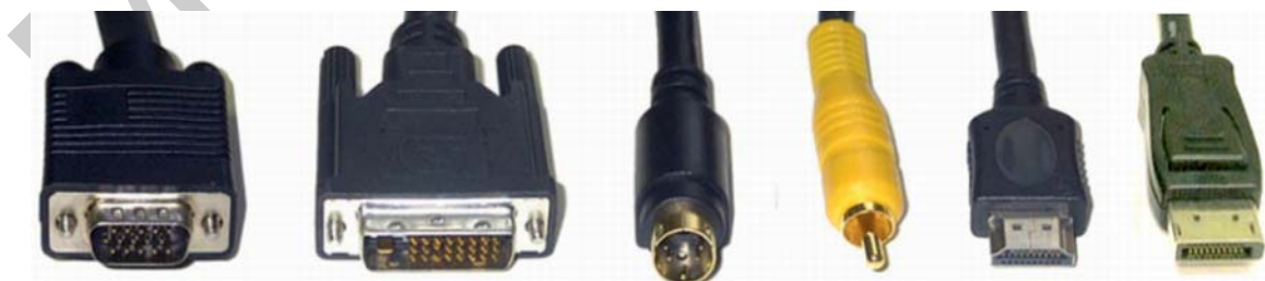
9. ábra. VGA (15 tűs D-SUB), DVI-D (-I), S-Video, Kompozit Video (RCA), HDMI, Display Port
