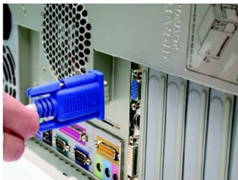
23. ábra. A VGA csatlakozó dugó eltávolítása, illetve a régi videokártya azonosítása 14
