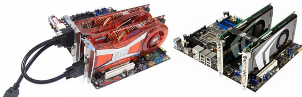
19. ábra. Az ATI Crossfire X1950 12 és az NVIDIA SLI megvalósítása
