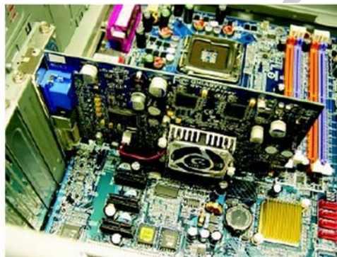
23. ábra. A VGA csatlakozó dugó eltávolítása, illetve a régi videokártya azonosítása 14
