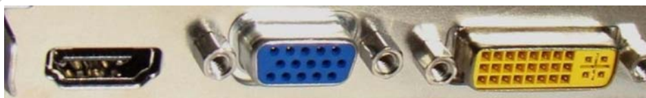
17. ábra. Nagyfelbontású HDMI, analóg D-Sub és digitális DVI aljzatok
