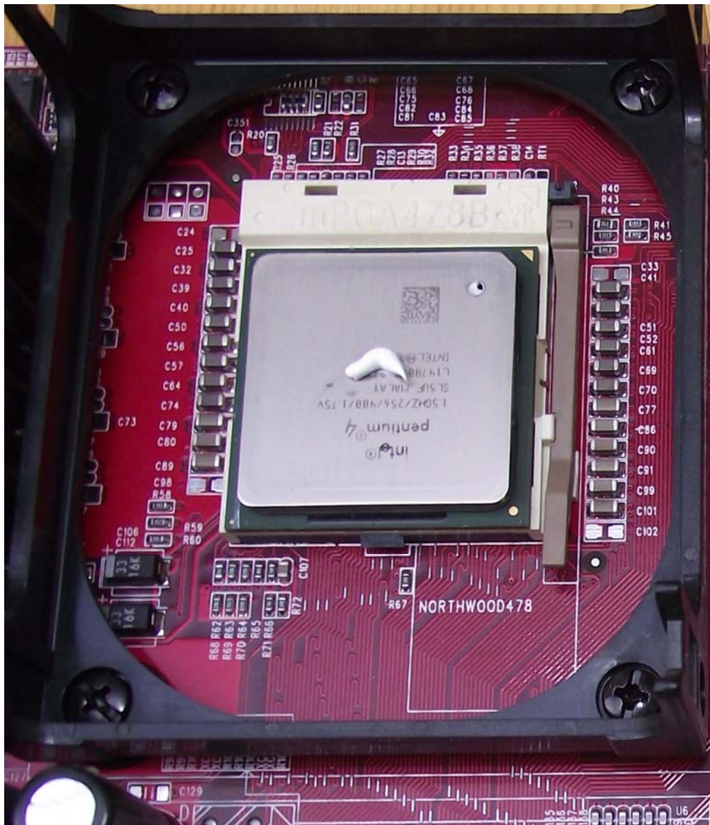
6. ábra. PGA típusú 478-as aljzat, már behelyezett processzorral, felületén szilikonpasztával
