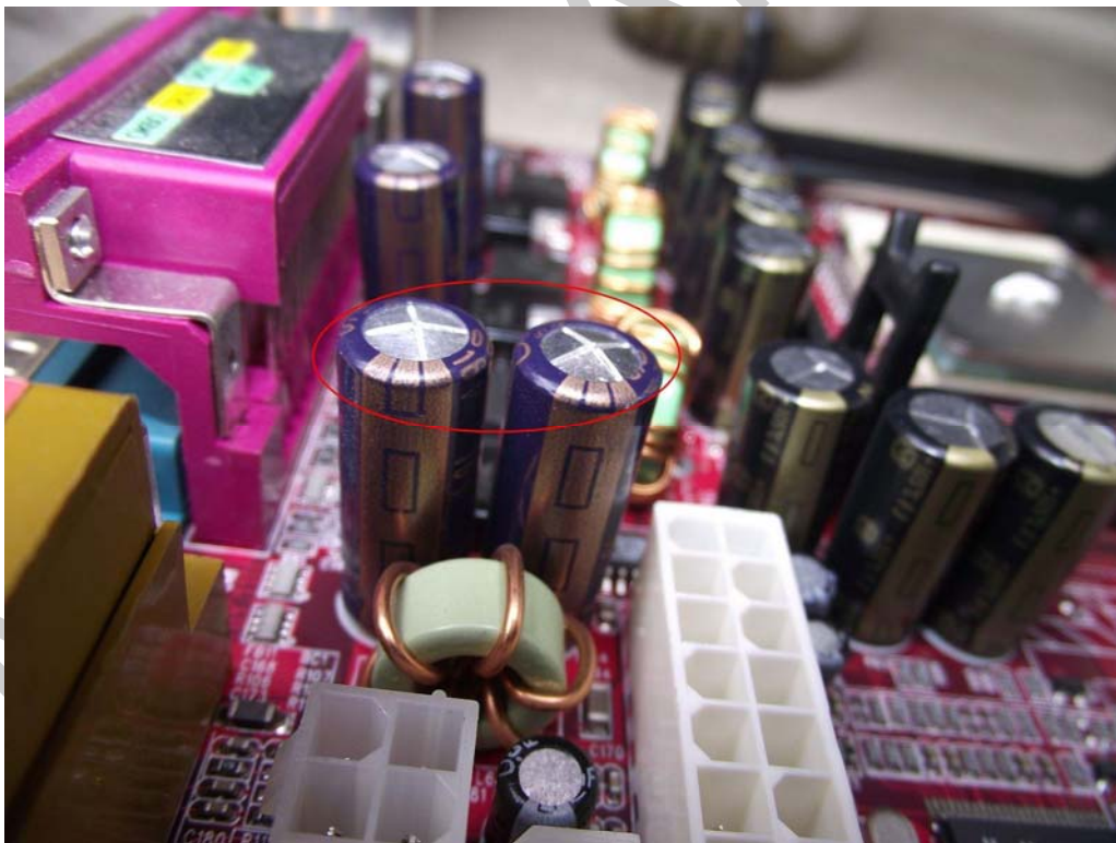
15. ábra. Felpúposodott, cserére szoruló elektrolit kondenzátorok
