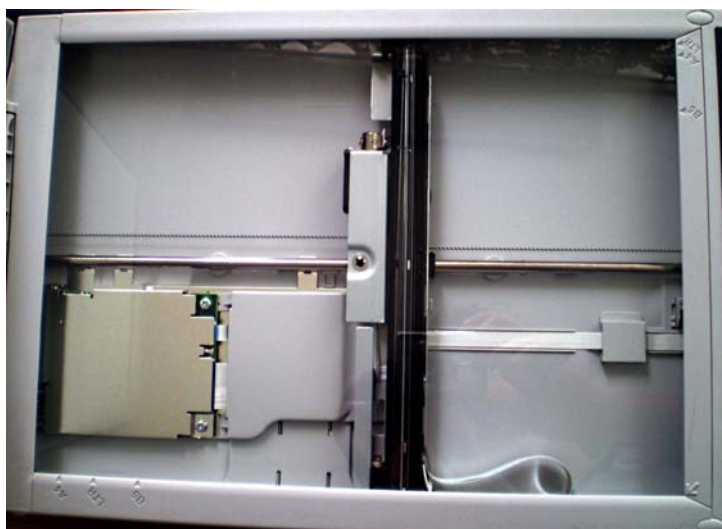
5. ábra Szkenner belső felépítése 5
