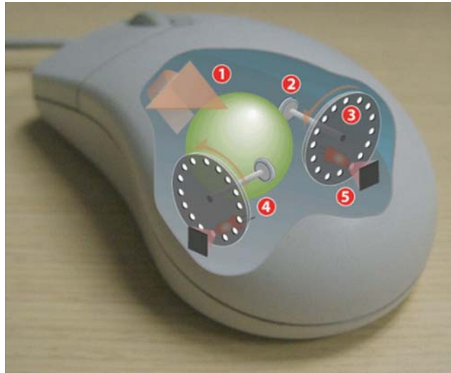
6. ábra. Az optomechanikus egér felépítése (forrás: Wikipedia.org)
