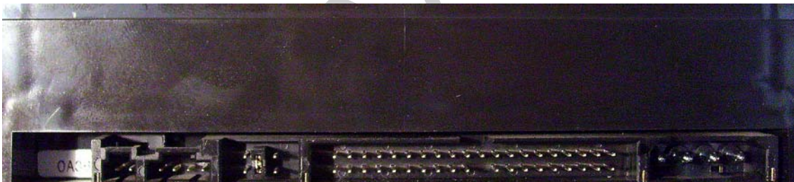
14. ábra PATA csatolófelületű DVD író 14
