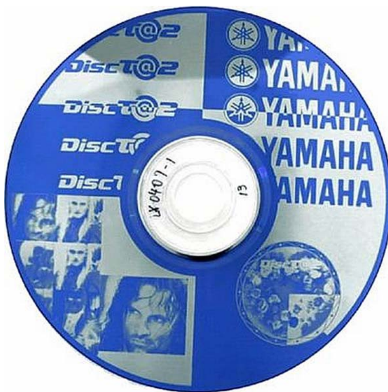
22. ábra Labelflash technológiával "gravírozott" DVD 22
