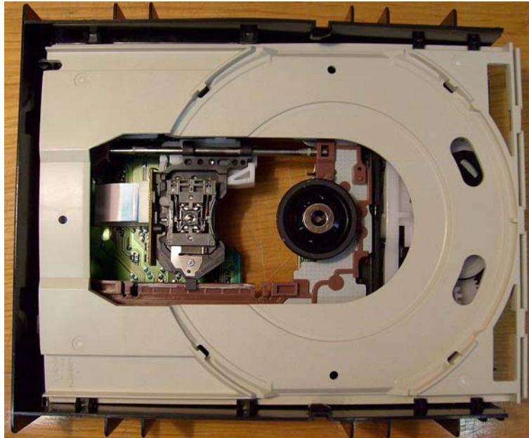
13. ábra DVD író belső felépítése 13
