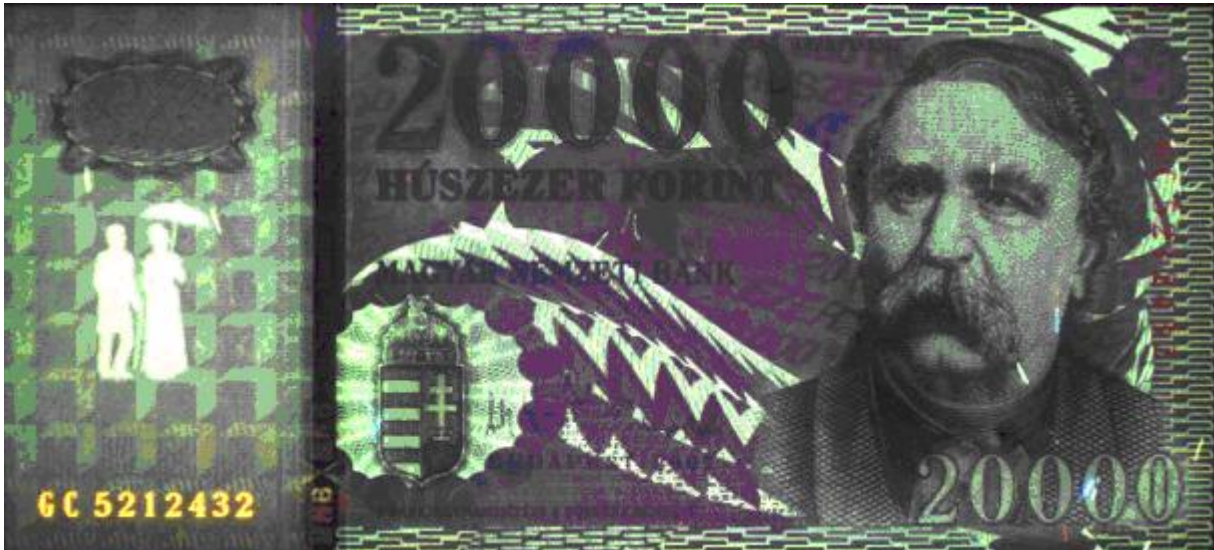
26. UV-A fényben zöldes színben világít a motívum és nem reagál a függőleges sorozatszám
