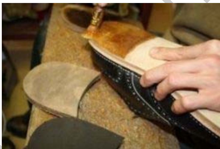
16. ábra. A lábbeli gyártása (saroképítés) 21
