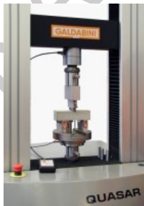
3. ábra. Anyagvizsgáló gép építőanyagokhoz (pl. nyomószilárdság vizsgálata) 4
