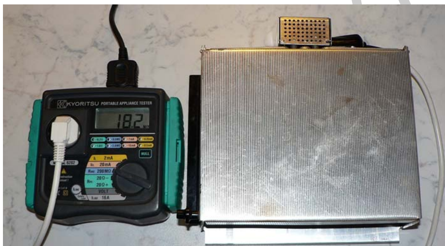
12. ábra. Szigetelési ellenállás mérése univerzális érintésvédelmi műszerrel
