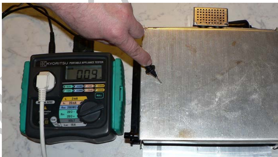
11. ábra. Védővezető mérése univerzális érintésvédelmi műszerrel
