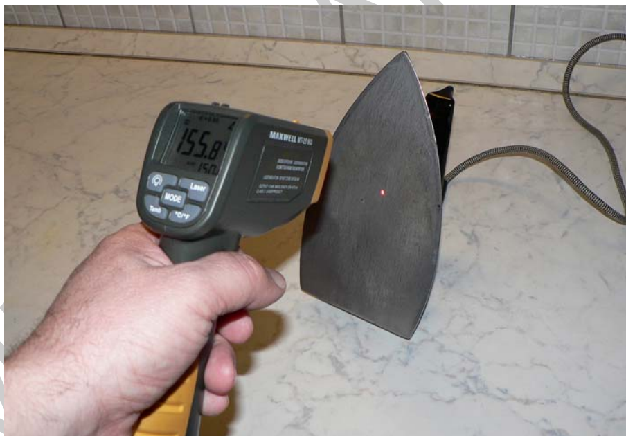
15. ábra. Hőmérséklet-szabályozó kikapcsolási hőmérsékletének ellenőrzése
