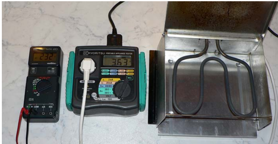
14. ábra. Teljesítménymérés V-A módszerrel
