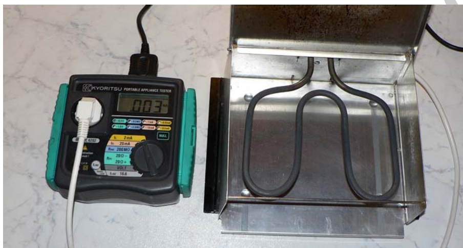
13. ábra. Szivárgóáram mérése
