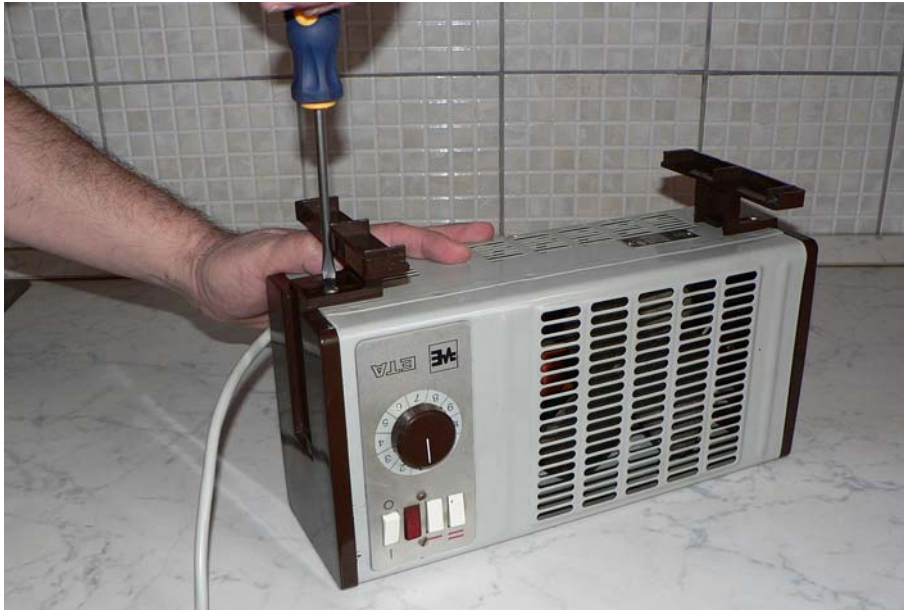
8. ábra. Oldallap leszerelése
