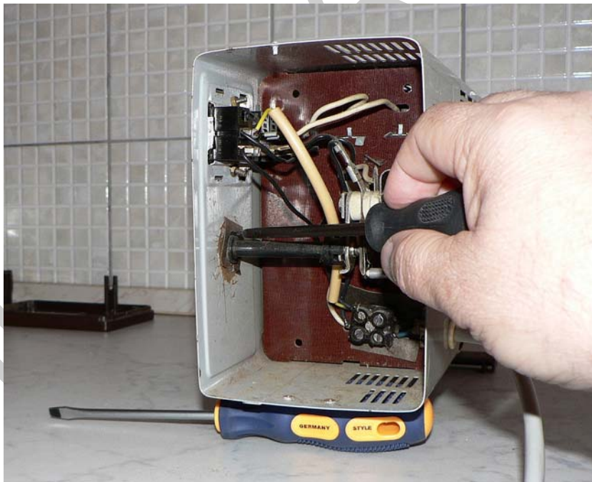
9. ábra, A hőmérséklet-szabályozó tengely kiszérése
