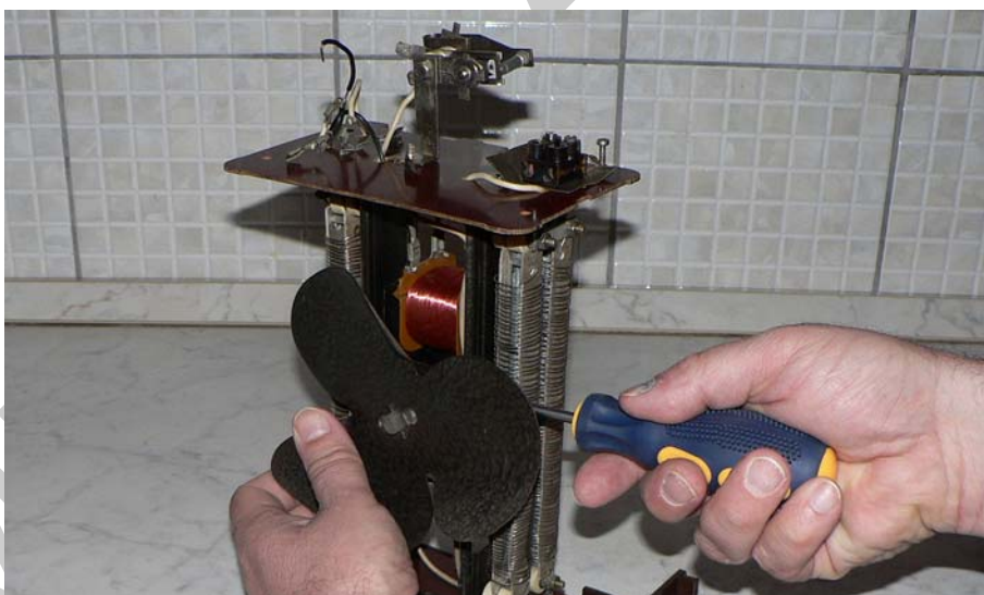
15. ábra. A ventilátorlapát lehúzása a motortengelyről.
