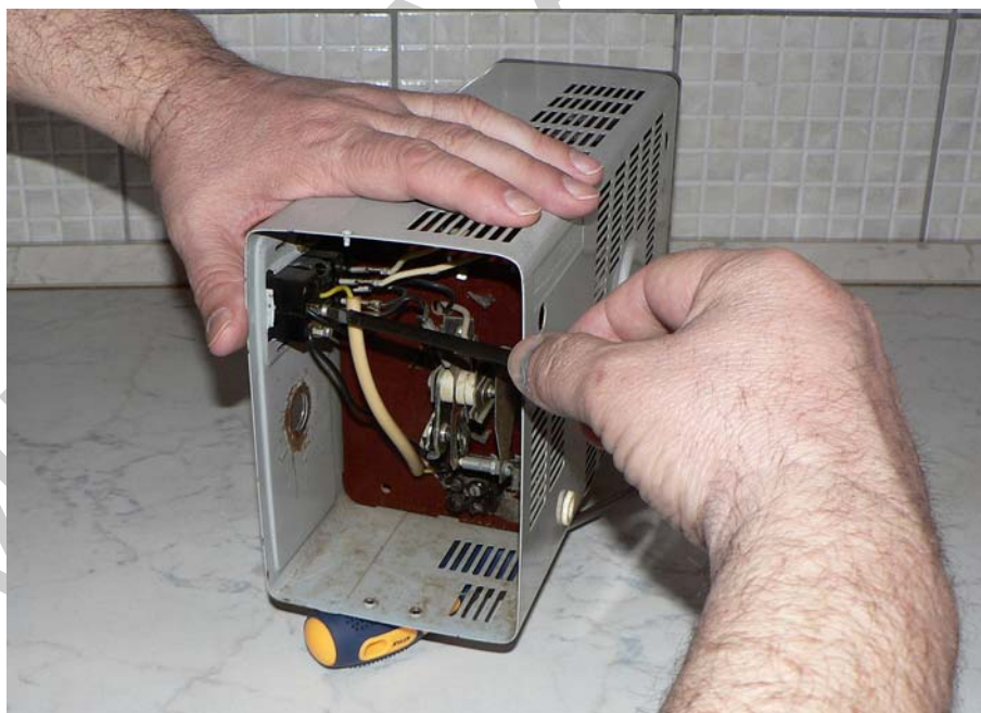
11. ábra. A jelzőlámpa és a kapcsolók kikötése
