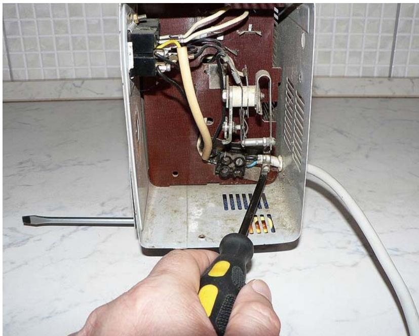
10. ábra. A tápvezeték eltávolítása
