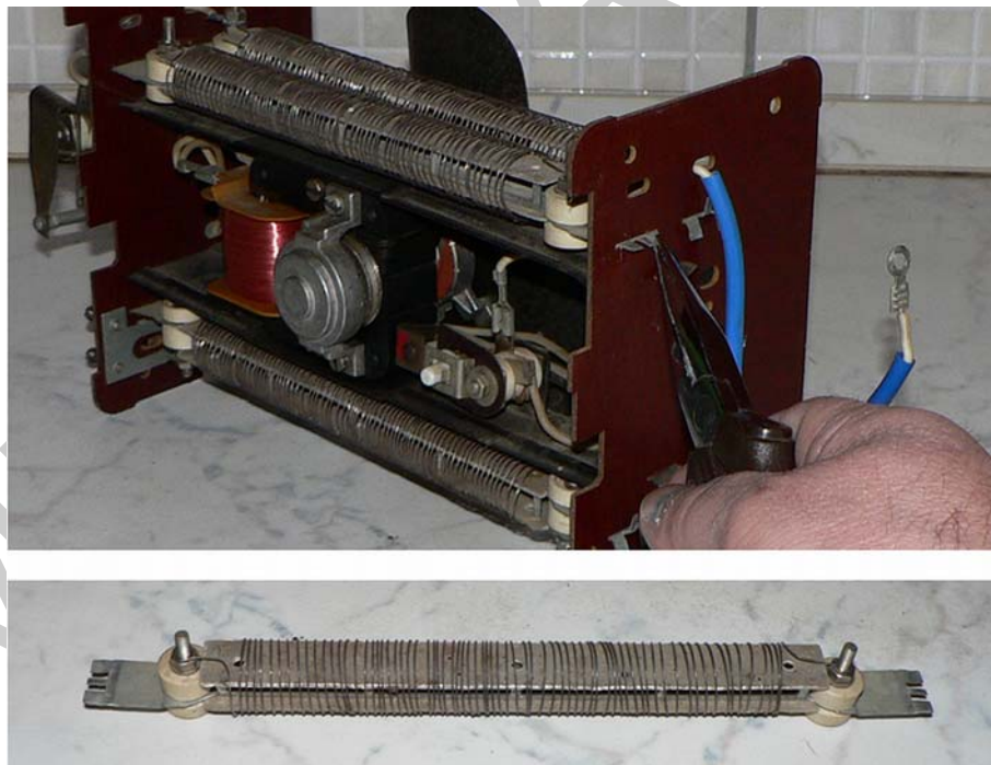
17. ábra. A fűtőtestek kiszerelése.
