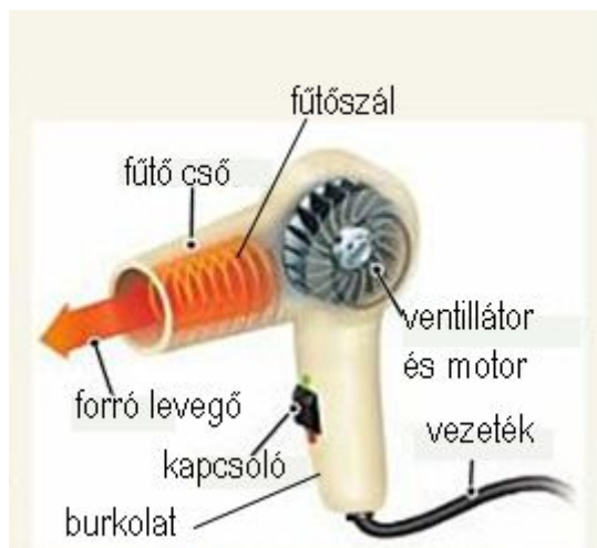
26. ábra. Hajszárító felépítése
