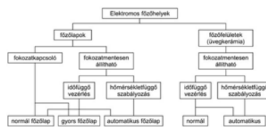
27. ábra. főzőlapok szerkezeti kialakítása 21
