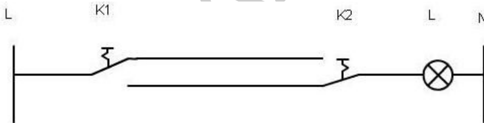
26. ábra. Váltókapcsolás, kikapcsolt állapot
