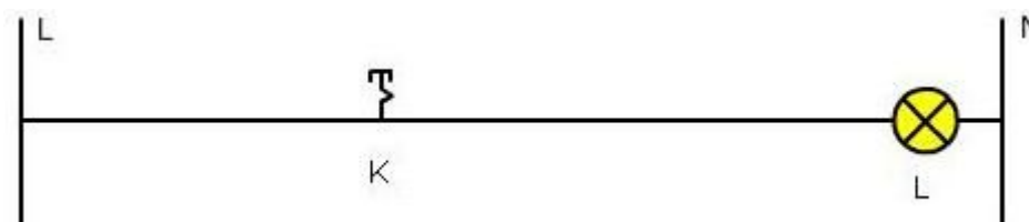
20. ábra. Egysarkú kapcsolás, bekapcsolt állapot
