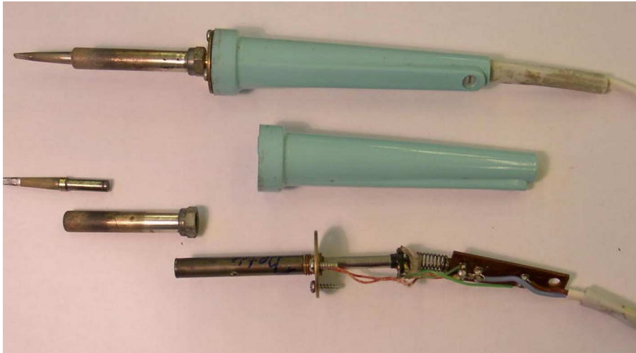
7. ábra. Curie-pontos szabályozású Weller páka
