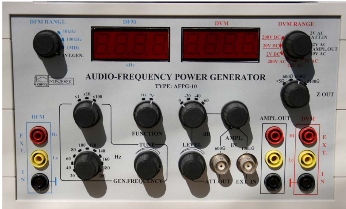
8. ábra. Jelgenerátor kezelőszervei
