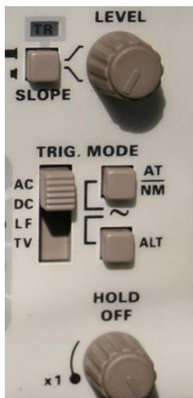
16. ábra. A szinkronizálás kezelőszervei
