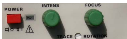
13. ábra. Az elektronsugárcső áramköreinek beállító szervei
