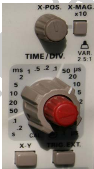
15. ábra. A vízszintes eltérítőrendszer szabályozó szervei
