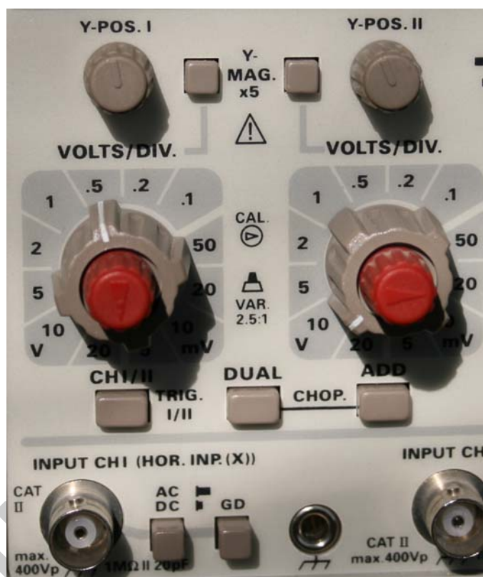
14. ábra. A függőleges eltérítés kezelőszervei
