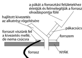
17. ábra. Felületszerelt alkatrész forrasztása 11
