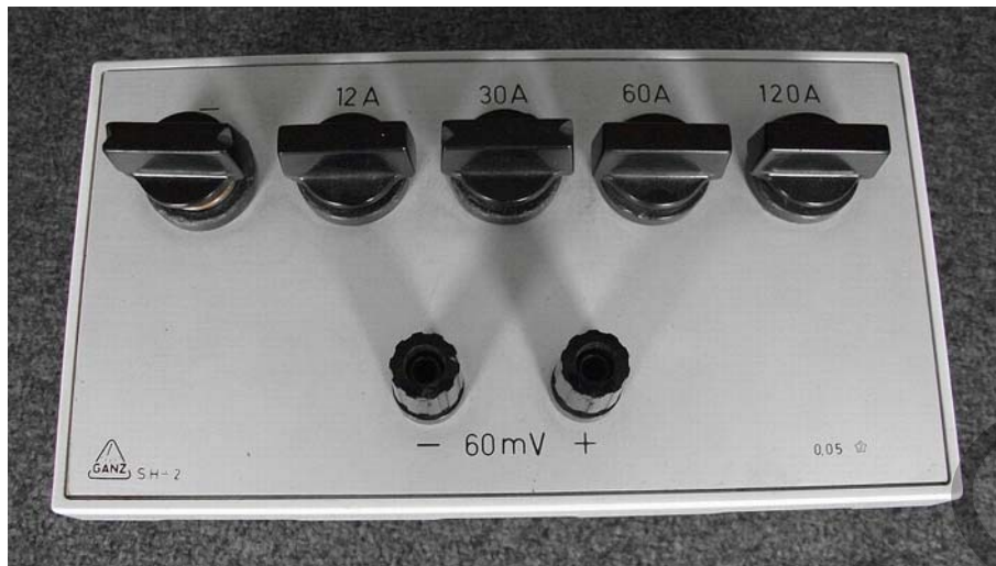
14. ábra. Gyári sönt-ellenállás a HDA-2 ampermérőhöz
