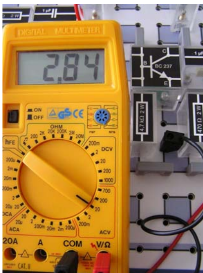
32. ábra. Kimeneti ellenállás mérés üresjárásban
