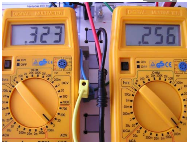
31. ábra. Bementi ellenállásmérés eredményei soros ellenállással
