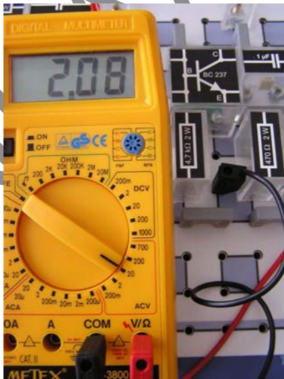
33. ábra. Kimeneti ellenállás mérés terheléssel
