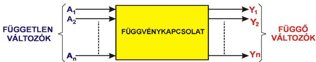
2. ábra. A logikai függvények szerkezete
